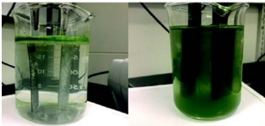
ภาพที่ 14 การตกตะกอนแบบ Electrocoagulation ของสาหร่าย
