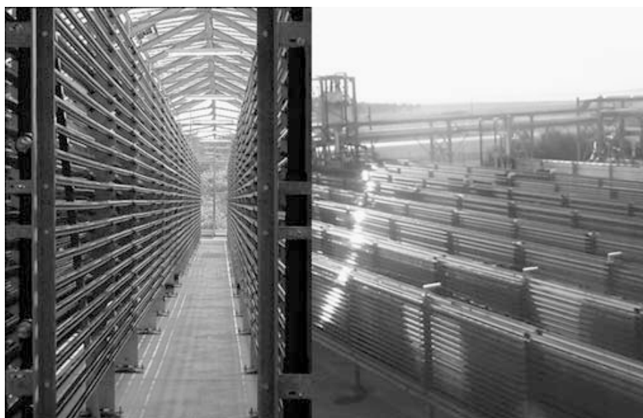
ภาพที่ 8 การเลี้ยงในระบบปิดเชิงพาณิชย์ใน tubular photobioreactor
