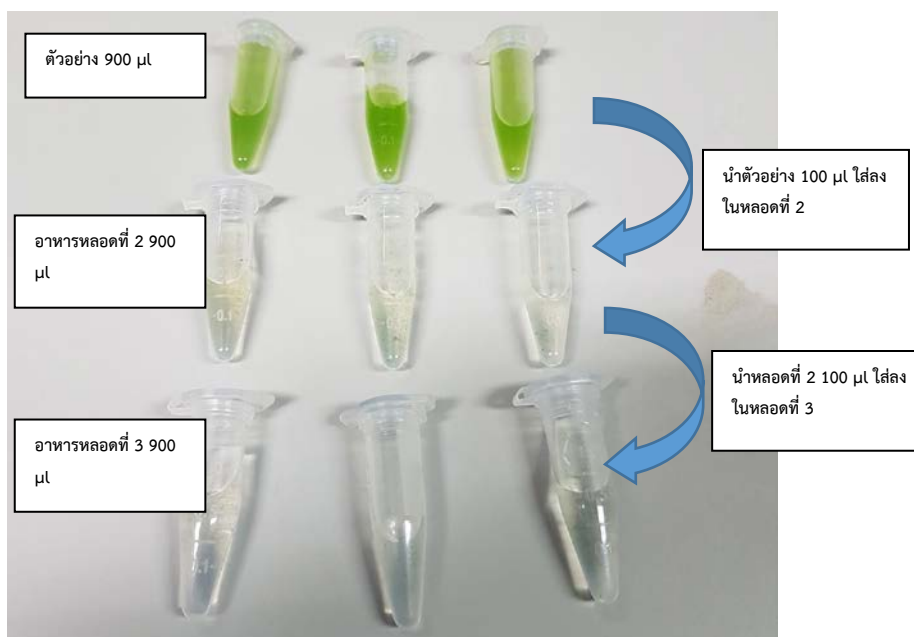
ภาพที่ 5 การทำการเจือจางแบบอนุกรม (Serial Dilution)
