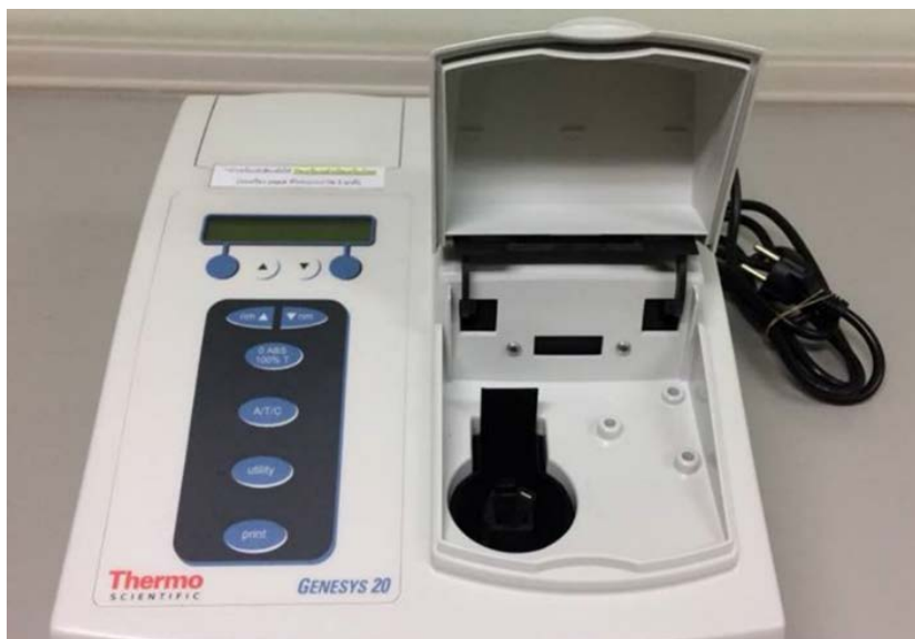
ภาพที่ 11 เครื่อง Spectrophotometer ที่ใช้สำหรับวัดการกระจายของแสงหรือความขุ่น
